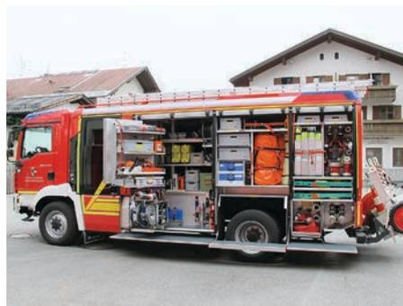
Mit dem HLF20 wurde ein Löschgruppenfahrzeug 16/12 aus dem Jahr 1983 ersetzt. Dieses Fahrzeug verfügt über Gerätschaften zur Technischen Hilfeleistung und Brandbekämpfung.
